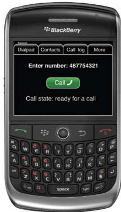
Rys. Przykładowy dialer umożliwiający użytkownikom telefonów komórkowych korzystanie z telefonii VoIP
